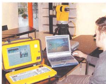
Erfasst dreidimensionale Räume und -objekte absolut detailgetreu: 3D-Laser-Messgerät von Callidus
