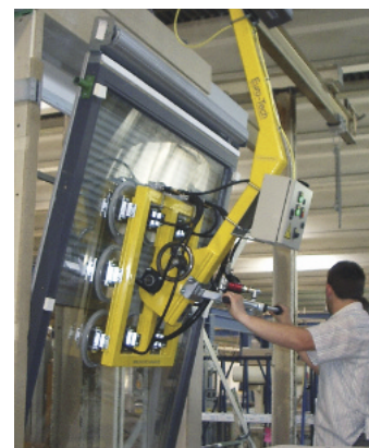
Fensterelemente werden mit Hilfe eines Vakuum-Hebegerätes in Fertig-hauswände eingesetzt
