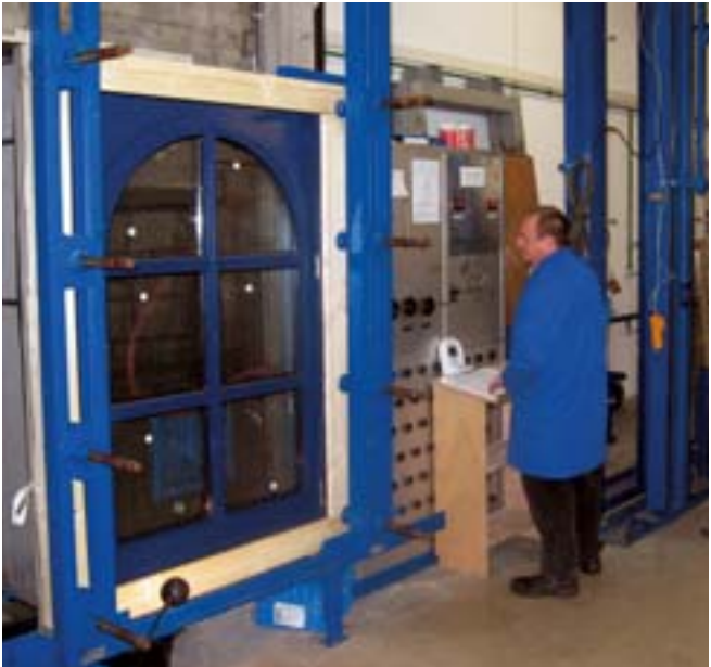
Ersttypprüfung im Prüfzentrum für Bauelemente an der Holzfachschule Bad Wildungen: Ob die nachzuweisenden Eigenschaften wohl erfüllt sind?
