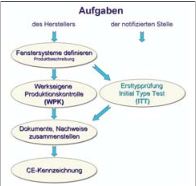
Ablauf und Aufgabenverteilung bei der Einführung eines CE-Kennzeichnungssystems in einem Fensterbaubetrieb
