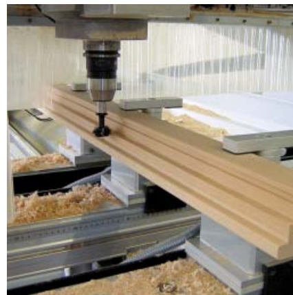
Die Profilierung wurde im wesentlichen mit Abrund- und Falzfräser hergestellt
