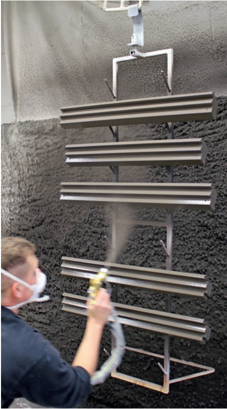
/ Bei Wildmeister werden die geschickt aufgehängten Einzelteile von Hand spritzlackiert.
