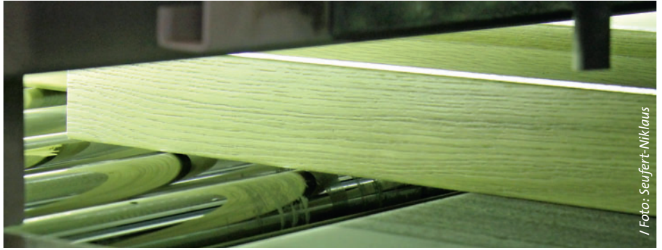
/ ... von Einzelteilen auch im Durchlauf mit einem Flächenspritzautomaten und verketteten Abluft- und Trocknungszonen und UV-Härtung erledigen.
