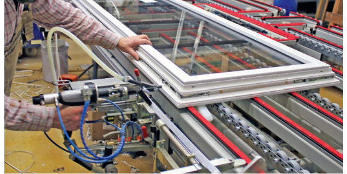
/ Hier werden die Eckbänder, Scheren und verdeckt liegenden Beschläge montiert. Im Anschluss daran wird die Verglasung dauerelastisch versiegelt.
