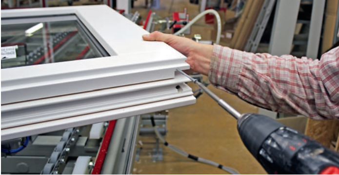
/ Mit speziellen Schrauben von SFS Intec, die für diese Art der Eckverbindung zugelassen und geprüft sind, wird der Rahmen verschraubt.
