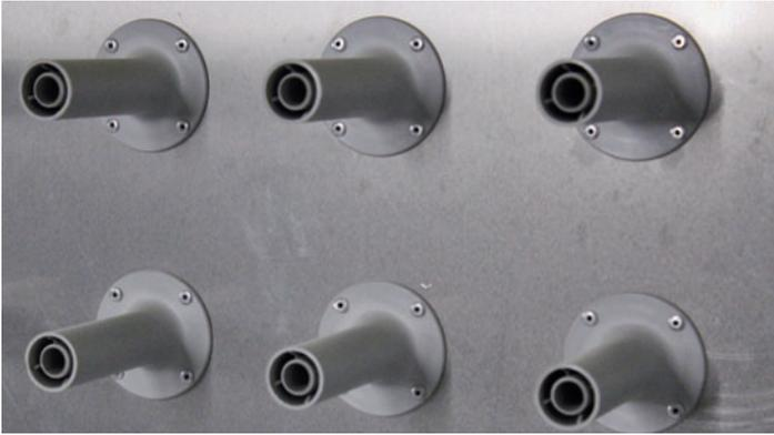
*/ Die 5-Kanal-Punktdüsen von Hygrex blasen mit hoher Geschwindigkeit sehr trockene Luft über die Oberflächen der gerade beschichteten Elemente.*
