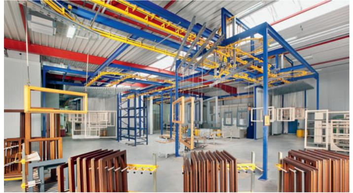
*/ Der Power-&-Free-Hängeförderer transportiert die Holzfenster mit 3 m/min durch die neue, 1400 m<sup>2</sup> große Oberflächenanlage.*
