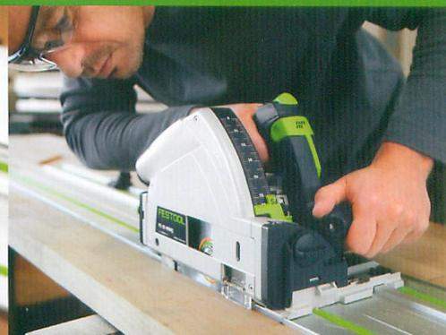
Neuer, federnd gelagerter Führungskeil: tritt vor dem Sägeblatt aus und kann bequem in einer bestehenden Schnittfuge angesetzt werden.
